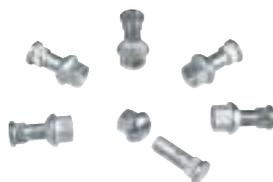
Kit axes de roue + écrous M10 L 35 - plat 17.
