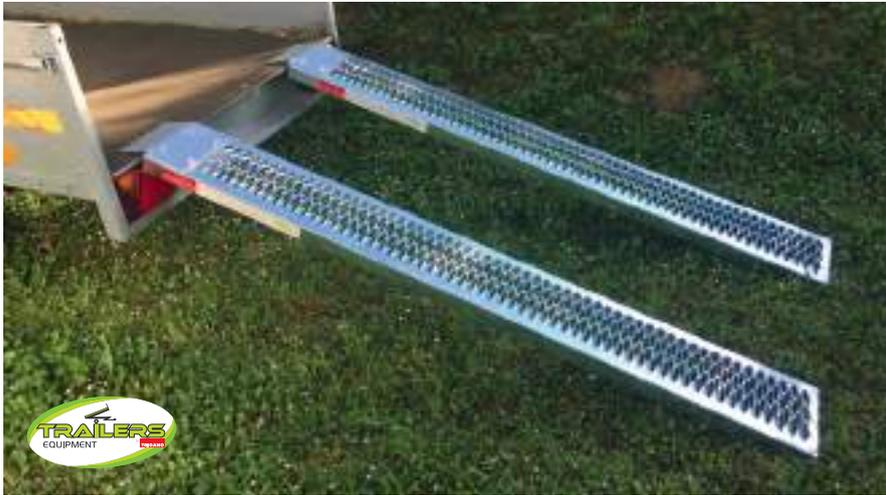
2 rampes galvanisées. Languette : 9 cm. Charge par paire : 350 kg.
